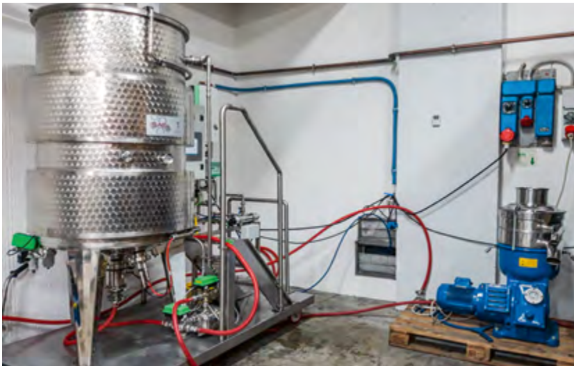
Foto 1 - Impianto pilota per la produzione di lievito in pasta direttamente in cantina realizzato in occasione del progetto, finanziato dalla Regione Toscana, VICASTART
