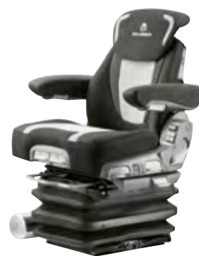
Figura 1. Un moderno sedile a sospensione pneumatica; la struttura di sospensione è nascosta dal soffiato in gomma posto sotto la seduta (fonte: Grammer)
