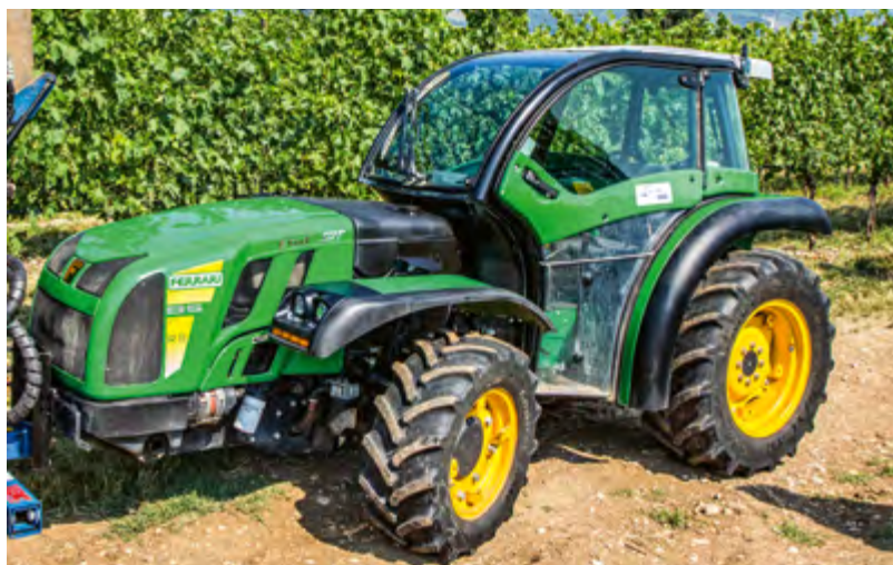
Figura 6. L'utilizzo di cabine, anche se di piccole dimensioni o ribassate, riduce notevolmente il carico acustico all'operatore, grazie principalmente all'utilizzo di materiali fonoisolanti e fonoassorbenti
