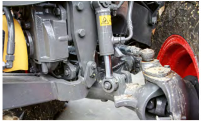
Figura 3. Dettaglio di un cilindro idraulico di un assale anteriore a sospensione tradizionale
