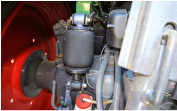
Figura 2. Un esempio di sospensione mista meccanico-idraulica della cabina
