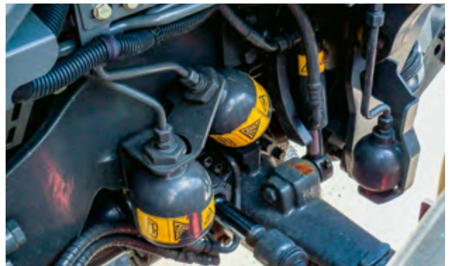
Figura 5. Tutte le tipologie di sospensioni anteriori si basano su accumulatori ad azoto inseriti all'interno del circuito idraulico
