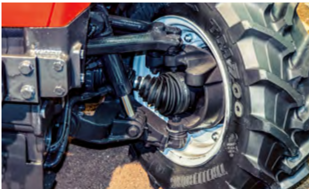
Figura 4. Una sospensione anteriore a ruote indipendenti; si noti il cilindro idraulico e il parallelogramma articolato
