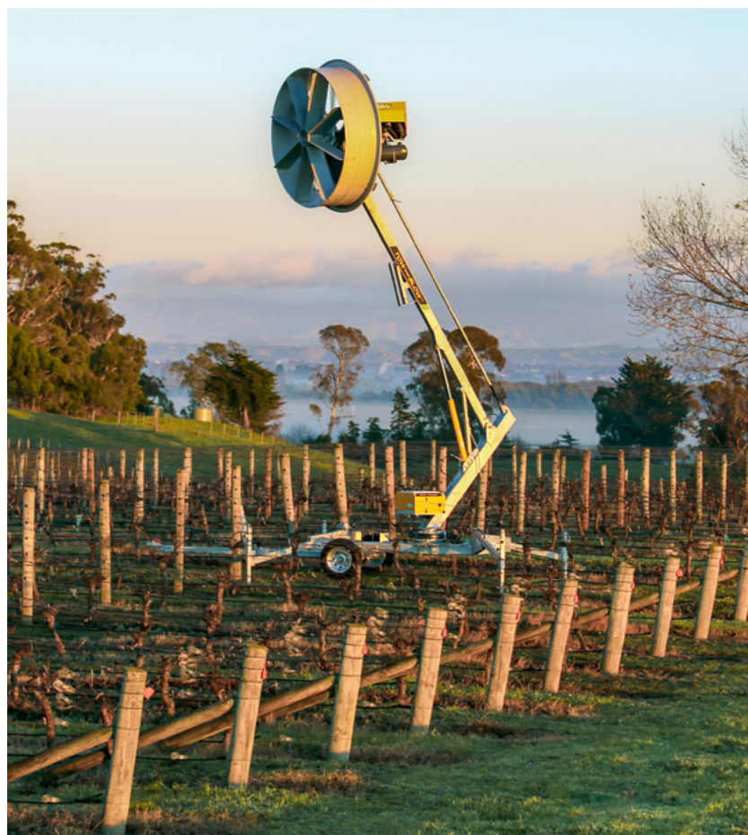
Figura 1 - Torre di ventilazione mobile per la prevenzione delle gelate. (credits: Volentieri Pellenc)
